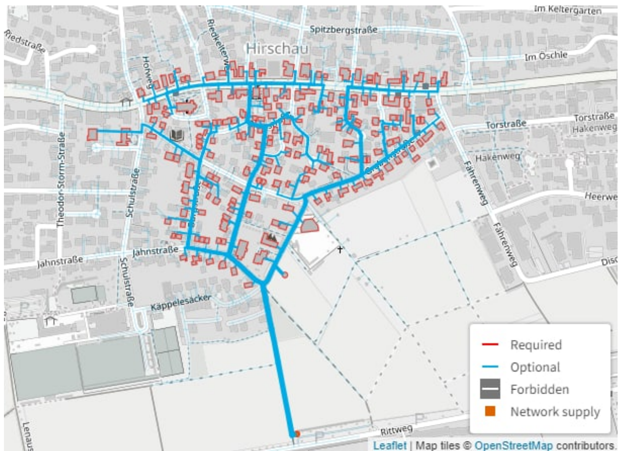
Abbildung 5.2: Im THERMOS-Tool entwickeltes Wärmenetz für eine erste Ausbaustufe mit Energiezentrale im Gewerbegebiet Rittweg Nord und Erschließung von Neubaugebiet und Ortskern [180]
